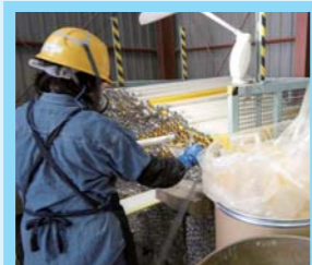
被膜付蛍光灯の場合は手作業で被膜をはがします。
